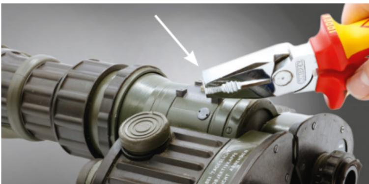
3. Adapter aufsetzen, mit der großen Halteschraube und zusätzlich vier kleinen 2,5mm Schrauben verschrauben.
