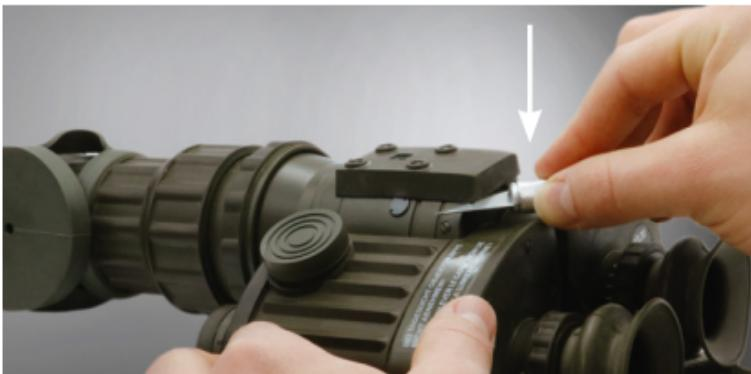
2. Die bauseits vorhandenen Schrauben mit einem geeigneten Werkzeug, z. B. einer kleinen Zange, entfernen.
